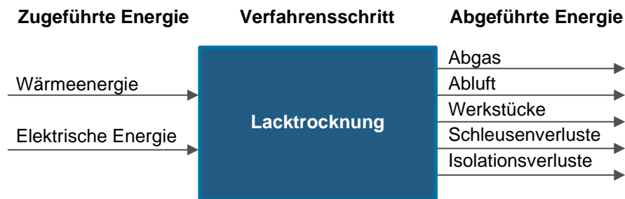
Abbildung 3-5: Energieströme in einem Umlufttrockner [11]
